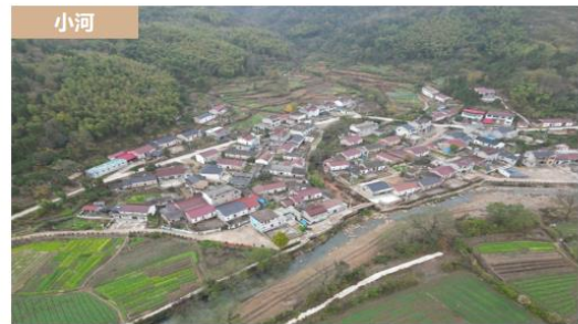
小河 —住宅建筑为二层为主，沿道路东侧布置，材质多采用红砖，主色调采用白色、红色，屋顶为坡屋顶，大部分住宅建筑质量较好。
