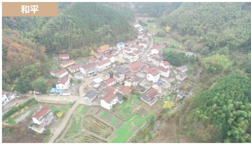
和平 —建筑以二层为主，住宅建筑材质多采用红砖为主，外立面白石灰抹缝处理，主色调采用白红为主，屋顶多为坡屋顶，以红色为主，部分住宅建筑外墙裸露，6栋建筑质量较差，村庄总体肌理完整。
